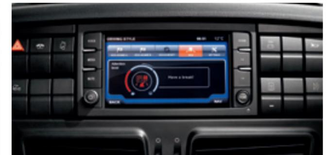
**DRIVER ATTENTION SUPPORT:** TRAMITE L'ANALISI DELL'AZIONE SUL VOLANTE, IL SISTEMA È IN GRADO DI CONTROLLARE IL LIVELLO DI ATTENZIONE DEL CONDUCENTE, PROTEGGENDOLO DALLA STANCHEZZA E DAI COLPI DI SONNO. IN QUESTI CASI, UN MESSAGGIO SULLO SCHERMO E UN SEGNALE ACUSTICO INVITANO IL GUIDATORE A UNA SOSTA.
